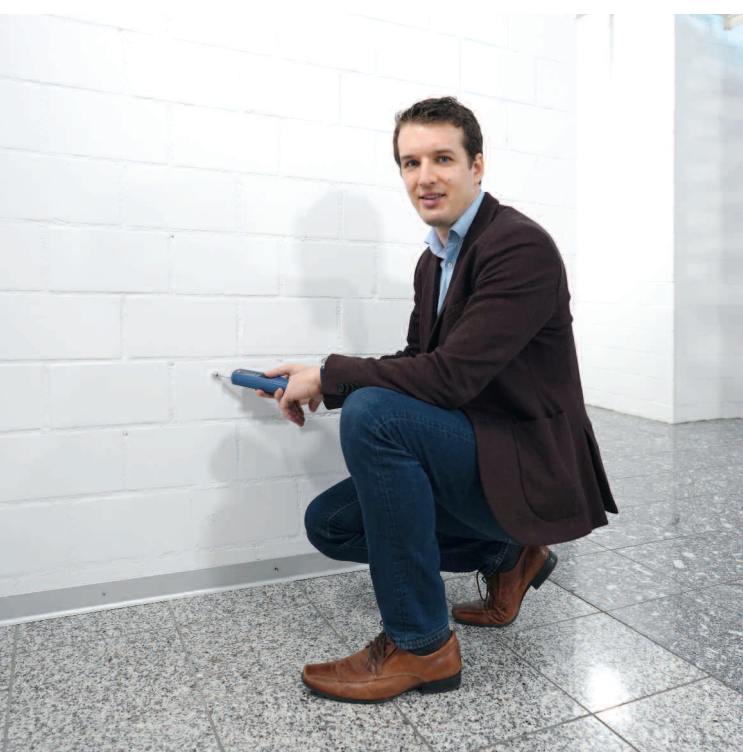
Dimitri Spori, specialista in sinistri per le assicurazioni di cose di Visana, misura l'umidità dei muri dopo un danno causato dall'acqua in uno stabile.
